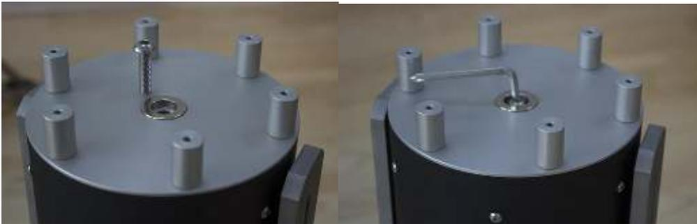
Ziehen Sie die Schraube mit dem beiliegende Imbusschlüssel fest an ohne Sie zu überdrehen..
