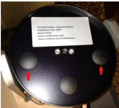
3. Nehmen Sie die beiden Plastikkappen (Pfeile) ab. Sie können mit der scharfen Seite eines Messers angehoben werden.
